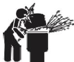
Les systèmes de circulation fonctionnent sous haute pression. Lors de l'entretien d'un élément du système de circulation (anneau de fermeture, pompe, filtre, vannes, etc.), de l'air peut pénétrer dans le système et le mettre sous pression. L'air sous
